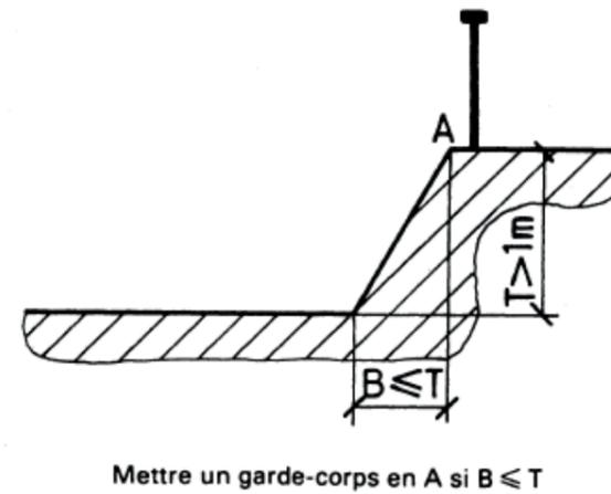
Figure 2 — Dénivellation avec la zone de réception supérieure à 1 m (cas des talus par exemple)
