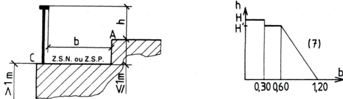
Figure 1 — Dénivellation avec la zone de réception, inférieure à 1 m
