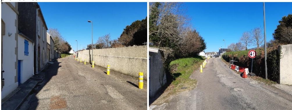
Vue générale actuelle de la voie avec cheminement pédestre de rive sécurisé par la pose de quilles J11 provisoires.
